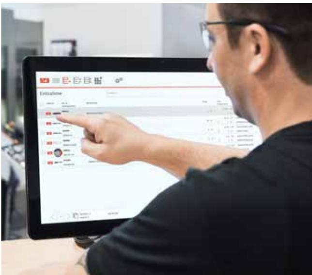
Die Bestellung via toolLOG® wird über den stationären Touchscreen oder das Tablet mit dem dazugehörigen Scanner ausgelöst.
